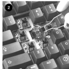
付属のキースイッチプラーをキースイッチの上下のツメに引っ掛けた後に引き抜きます。
